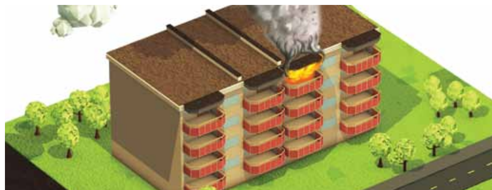
2. En brann her vil mest sannsynlig begrense seg til denne ene balkongen i tilstrekkelig tid til at brannvesenet får startet slukking. Dette er takket være brannventilene og den ubrennbare himlingen som vil forsinke og forhindre brannspredningen vesentlig. Dersom brannen likevel skulle spre seg i taket, vil branncelleinnstillingen hindre at andre seksjoner blir berørt.
