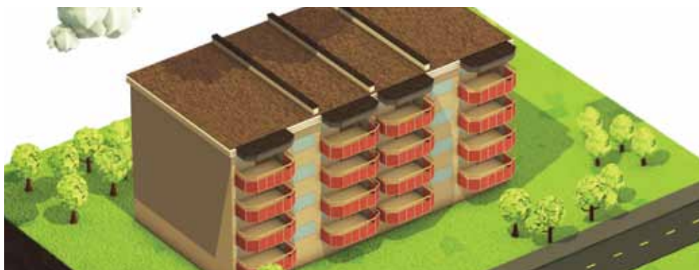
1. På denne blokka er platene i himlingen over de øverste balkongene ubrennbare og hovedtaket er oppdelt i brannceller.
